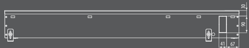
Вид сбоку конвектора Qtherm 370.150 с U-образным бортом
