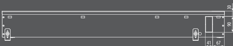
Вид сбоку конвектора Qtherm 300.150 решеткой с U-образным бортом
